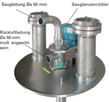
Bild 3: Schlauchmontage
