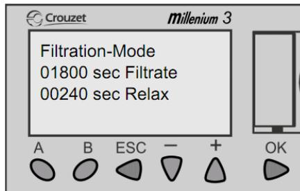
Um im Langzeitbetrieb das Verblocken der Membranfilter zu verhindern, ist im Recycling-Modus ein Entspannungsintervall eingeschoben. Alle x Sekunden stellt der Membranfilter seinen Betrieb für die Dauer von y Sekunden ein, so dass für diesen Zeitabschnitt kein transmembraner Druck auf die Membranplatten einwirkt. Das Ergebnis dieses Reinigungsprinzips ist ein deutlicher Anstieg der Permeabilität. Der Zeitwert für *Filtrate* ist festgeschrieben und lässt sich nicht verändern.
