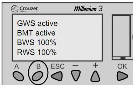
Im Grauwasserspeicher (GWS) ist Grauwasser zur Aufbereitung vorhanden (active).
