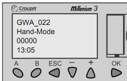
Die derzeit aufgespielte Programm-Version der GEP-Steuereinheit kann in der obersten Zeile abgelesen werden. Im Handmodus lassen sich alle Anlagenkomponenten zur Überprüfung direkt manuell ansteuern. Die unterste Zeile zeigt die aktuelle Uhrzeit in der GEP-Steuereinheit an.
