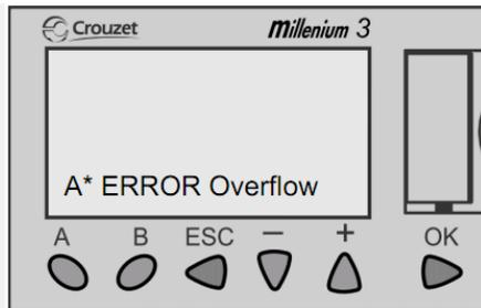
Der Füllstand im Betriebswasserspeicher beträgt mehr als 100%!
