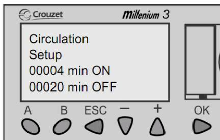
Dieser Menüpunkt regelt und steuert in Abhängigkeit des Vorlagevolumens die Umwälzhäufigkeit und –dauer zwischen Grauwasserspeicher und *BMT*-Einheit. Dadurch wird das Grauwasser im Grauwasserspeicher zyklisch mit Sauerstoff aus der *BMT*-Einheit für mikrobiologische Abbauvorgänge angereichert.
