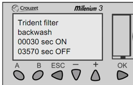
Der Grobfilter *Trident* wird in zyklischen Abständen vollautomatisch mit Betriebswasser gereinigt. Die Häufigkeit der Reinigung richtet sich dabei nach dem Verschmutzungsgrad des Grauwassers und der Menge an groben Wasserinhaltsstoffen (> 1 mm). Um eine hohe Wasserausbeute des GEP-Grobfilters zu garantieren, sollte mehrmals täglich die Sprüheinheit aktiviert werden.
