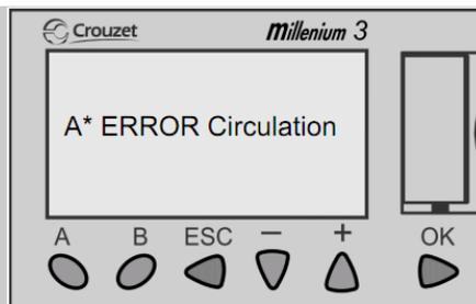
Die Umwälzung des Grauwassers zwischen Grauwasserspeicher und *BMT*-Einheit funktioniert nicht. Die Störmeldung muss mit (OK) quittiert werden.
