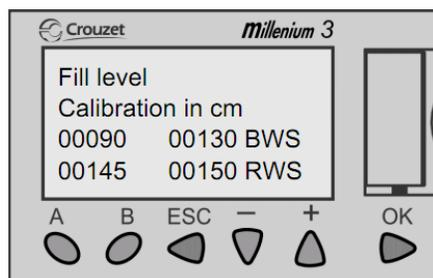
In diesem Menüpunkt kann der Füllstand für den Betriebswasserspeicher (BWS) und den Regenwasserspeicher (RWS) kalibriert werden. Die maximal zulässige Füllstandshöhe des betreffenden Speicherbehälters wird in Zentimetern (cm) angegeben und entspricht einem Füllstand von 125%. Die Zahlenwerte auf der linken Seite geben den gegenwärtigen Füllstand in Zentimeter (cm) wieder.
