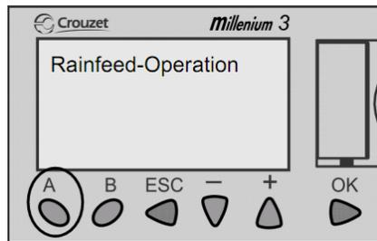
Zuschaltung einer externen Regenwassernachspeisung mithilfe einer Zubringerpumpe. Der Automatik-Betrieb des GEP-Wassermanager bleibt dabei aufrecht erhalten.
