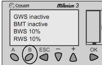
Im Grauwasserspeicher (GWS) ist kein Grauwasser zur weiteren Aufbereitung vorhanden (inactive). In der *BMT*-Einheit steht der Membranfilter nicht mehr unter Wasser (inactive)! Dies löst eine Störmeldung im Hauptmenü aus. Mehr Informationen zu Störmeldungen in Kapitel 9.
