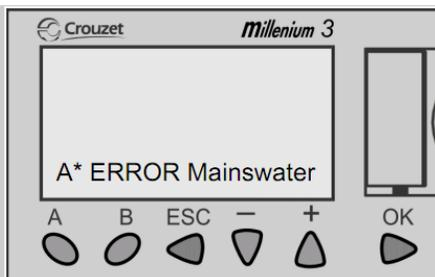
Die automatische Trinkwassernachspeisung ist von der GEP-Steuereinheit gesperrt worden!
