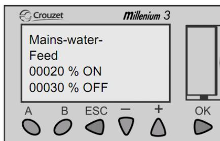
In diesem Menüpunkt kann der Füllstandswert des Betriebswasserspeichers angegeben werden, bei dem sich die automatische Trinkwassernachspeisung aktivieren und deaktivieren soll. Der Mindesteingabewert für *ON* beträgt 5%.
