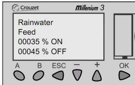
In diesem Menüpunkt kann der Füllstandswert des Betriebswasserspeichers angegeben werden, bei dem sich die automatische Regenwassereinspeisung aktivieren und deaktivieren soll. Der Mindesteingabewert für *ON* beträgt 5% oberhalb der Trinkwassernachspeisegrenze.
