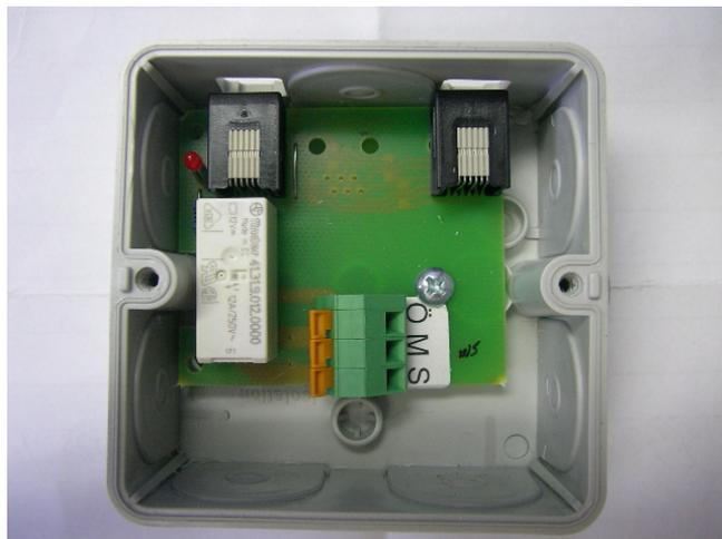
Durchstoßen sie die Kabeldurchführung mit einem spitzen Gegenstand und schieben ihr Kabel, für den potentialfreien Kontakt, durch diese Öffnung. In der nachfolgenden Tabelle ist die Anschlussfolge aufgeführt.
