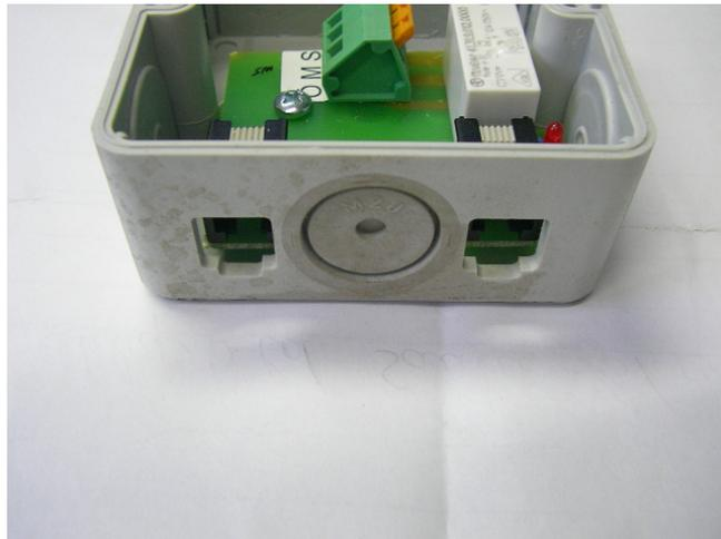
Die RJ 45 Dose (Westernstecker 6 pol.) wird über das beiliegende Kabel mit der Systemsteuerung verbunden. Hierbei kann jede Dose angeschlossen werden. Die zweite Dose ist für weitere Zusatzfunktionen vorgesehen.
