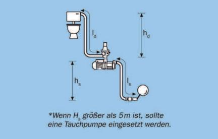
\*Wenn  $H_s$  größer als 5 m ist, sollte eine Tauchpumpe eingesetzt werden.
