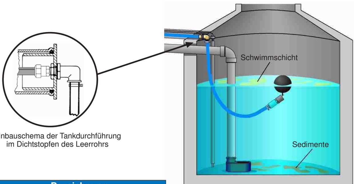
Einbauschema der Tankdurchführung im Dichtstopfen des Leerrohrs
