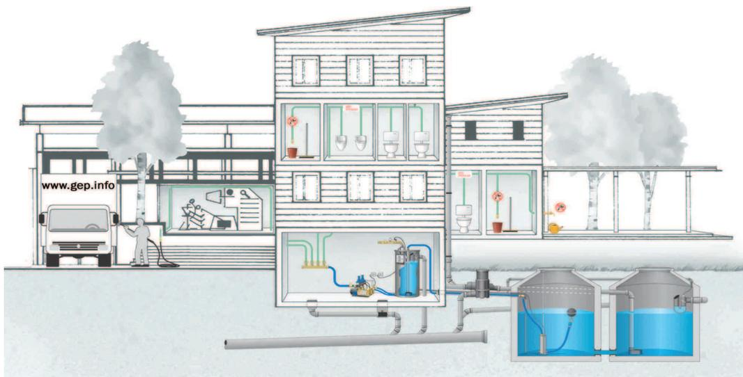
Dieses Schema zeigt die Kombination eines Hybridsystem mit Zubringerpumpe und einer Doppelpumpen-anlage.
