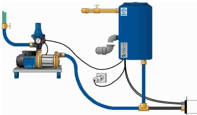
Dieses Schema zeigt die Kombination des Hauswasserkes mit einer Systemsteuerung TEO zur bedarfsgerechten Trinkwassernachspeisung bei Regenwassermangel im Auffangbehälter.
