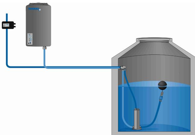
Dieses Schema zeigt die Kombination der Tauchpumpe mit einer Systemsteuerung TE0 zur bedarfsgerechten Trinkwassernachspeisung bei Regenwassermangel im Auffangbehälter.
