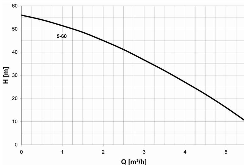
Diese Übersicht basiert auf einer kinematischen Viskosität von 1 mm<sup>2</sup>/s und einer Dichte von 1.000 kg/m<sup>3</sup>.
