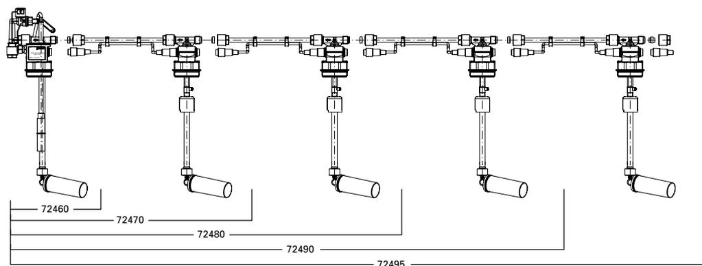
Die Servicepakete werden für Tankhöhen bis 1.850 mm geliefert und für Tankmittenabstände 870 mm.
